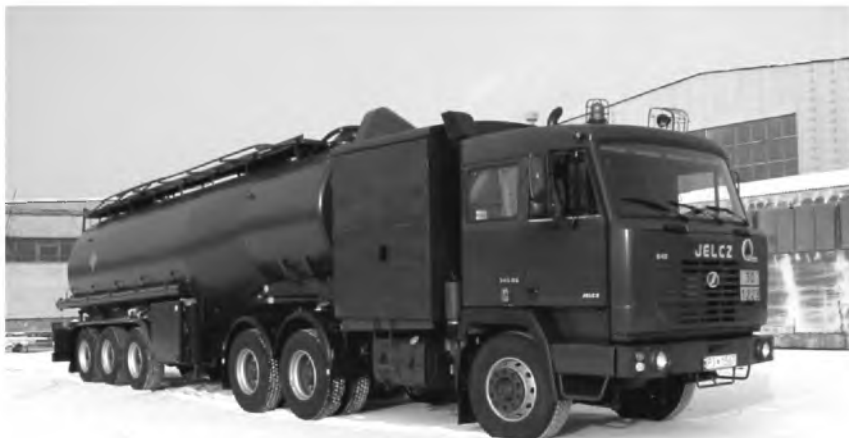
Fotografia 5. Cysterna dystrybutor Jelcz CP-10 do transportu i tankowania paliw lotniczych
